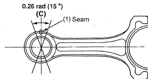
ALIGNING THE CONNECTING ROD
