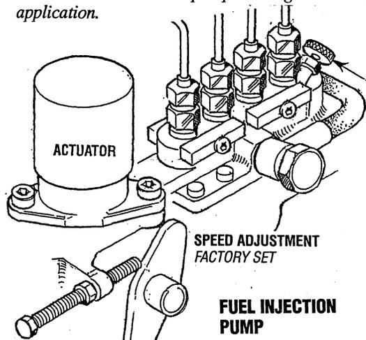
**BLEED SCREW - THE INJECTION PUMP BLEED SCREW SHOULD BE LEFT IN THE OPEN POSITION. THIS WILL ALLOW FOR AIR IN THE FUEL SYSTEM TO BE DELIVERED BACK THRU THE FUEL RETURN SYSTEM DURING ENGINE OPERATION.**
