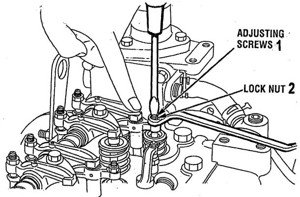
**VALVE CLEARANCE FACTORY SPEC. 0.23 - 0.27MM
